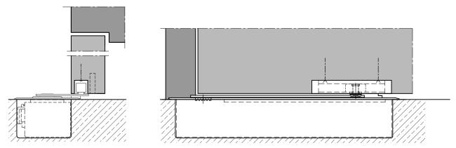
4.1 Bodentürschließer mit verdeckter Gleitschiene
