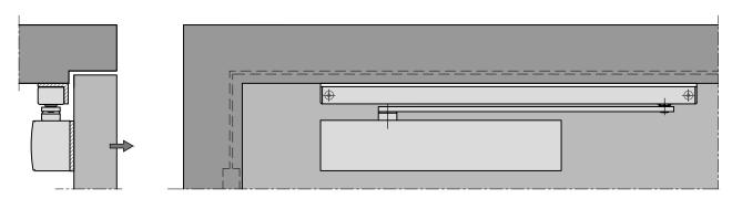
2.7 Gleitschienenschließer Türblattmontage Bandgegenseite mit Sturzfutterwinkel
