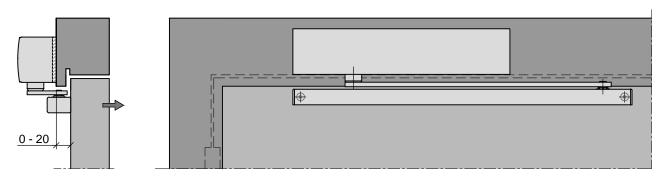
2.6 Gleitschienenschließer Kopfmontage Bandgegenseite
