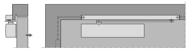
2.5 Gleitschienenschließer Türblattmontage Bandgegenseite
