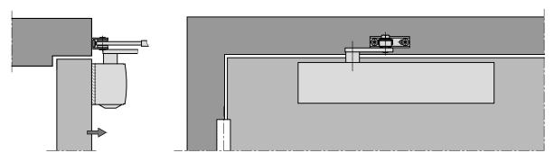
1.1 Scherenarmschließer Türblattmontage Bandseite (Türblatt stumpf)
