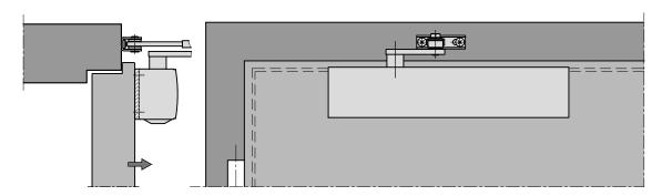
1.2 Scherenarmschließer Türblattmontage Bandseite (Türblatt gefälzt)
