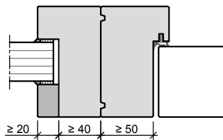
Kopplung Seitenteil / Tür Türblatt stumpf einliegend
