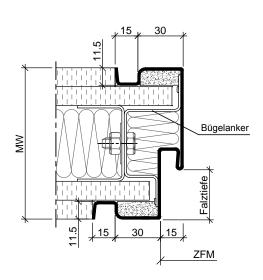
Stahlumfassungszarge zum wandbegleitenden Einbau in Montagewände wahlweise mit Schattennut
