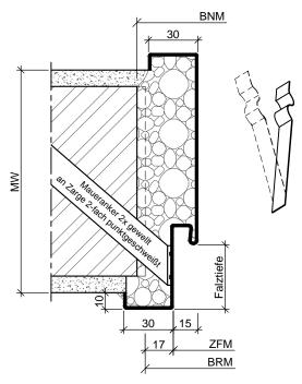
Stahlumfassungszarge mit Mauerankerbefestigung
