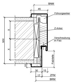
2-schalige Stahlumfassungszarge mit Z-Ankerbefestigung in Massivwand
