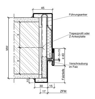
2-schalige Stahlumfassungszarge mit variabler Maulweite in Massivwand
