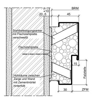
Blockzarge mit Schweißankerbefestigung in Parallelwandmontage
