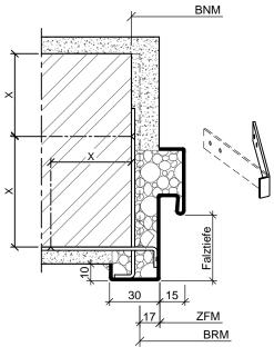
Stahleckzarge mit doppeltem Schraubanker
