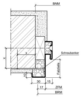
Stahleckzarge mit Rahmendübel und Schraubanker
