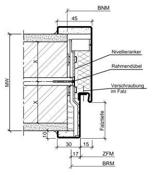
2-schalige Stahlumfassungszarge mit Nivellierankerbefestigung
