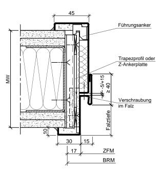
2-schalige Stahlumfassungszarge mit variabler Maulweite in Leichtbauwand
