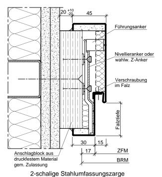
Nivellierankerbefestigung mit Anschlagblock in Leichtbauwand
