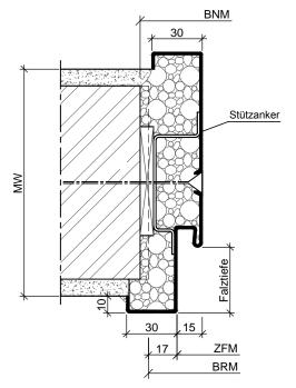
Stahlumfassungszarge mit Rahmendübel und Schraubanker Ausführung mit Stützanker
