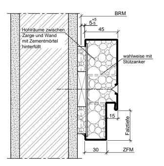
Blockzarge mit Rahmendübelbefestigung in Parallelwandmontage
