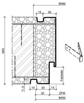
Stahlumfassungszarge mit doppeltem Schraubanker wahlweise mit Schattennut
