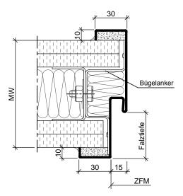
Stahlumfassungszarge zum wandbegleitenden Einbau in Montagewände
