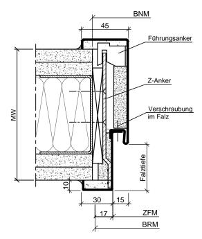
2-schalige Stahlumfassungszarge mit Z-Ankerbefestigung in Leichtbauwand
