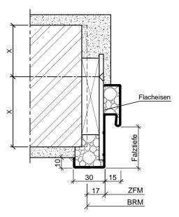
Stahleckzarge mit einfachem Schraubanker
