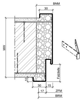
Stahlumfassungszarge mit doppeltem Schraubanker
