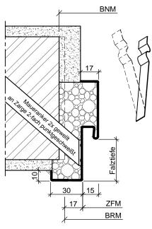
Stahleckzarge mit Mauerankerbefestigung
