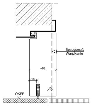
HW68-flächenbündig in Stahlzarge
