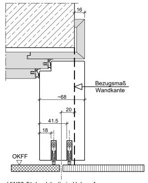
HW68-flächenbündig in Holzumfassungszarge 2 Bodendichtungen
