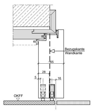
HW65-aufliegend mit Doppelfalz in Holzumfassungszarge (2. Bodendichtungen optional)
