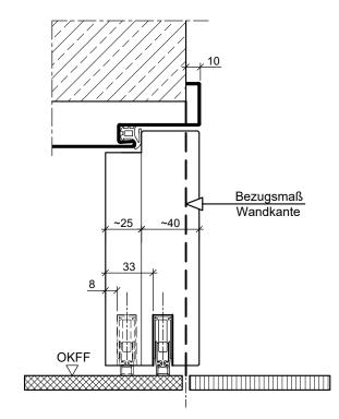
HW65-stumpf mit Leibungsfalz in Stahlzarge (2. Bodendichtungen optional)
