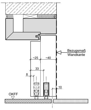
HW65-stumpf mit Leibungsfalz in Holzblockzarge (2. Bodendichtung optional)
