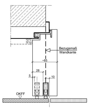
HW65-aufliegend mit Doppelfalz in Stahlzarge (2. Bodendichtungen optional)
