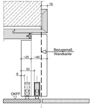
HW65-stumpf mit Leibungsfalz in Holzumfassungszarge (2. Bodendichtung optional)
