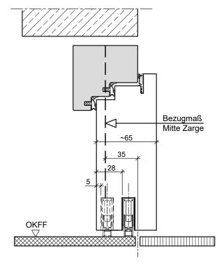
HW65-aufliegend mit Doppelfalz in Holzstockzarge (2. Bodendichtungen optional)
