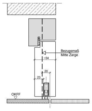
HW54-stumpf mit Leibungsfalz in Stockzarge
