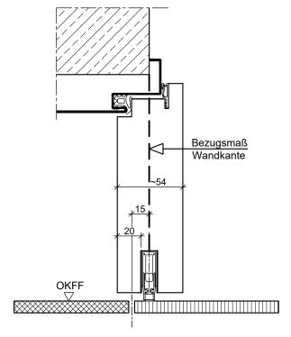
HW54-aufliegend mit Doppelfalz in Stahlzarge
