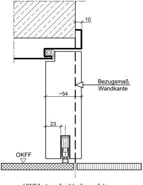
HW54-stumpf mit Leibungsfalz in Stahlzarge
