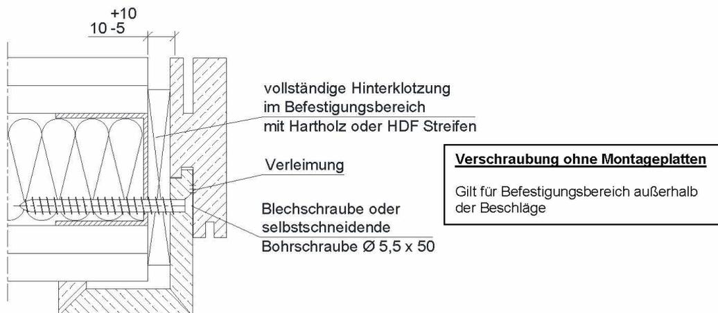
**Abbildung 5: Befestigung in Montagewand**
