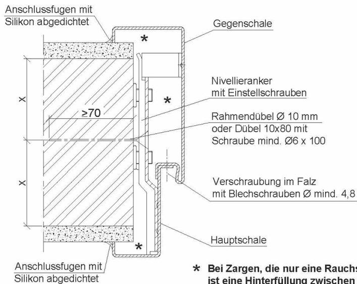
Bei Rauchschutzanforderung in Zusammenhang mit Schallschutzanforderung müssen die Hohlräume zwischen Zargenrückseite und Wand vollständig mit Mörtel, Mineralwolle oder 2-K Montageschaum hinterfüllt werden.
